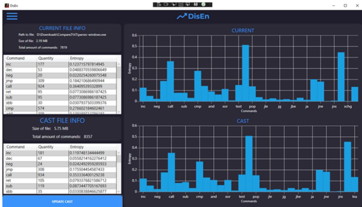
Рисунок 1 – Приклад розрахунку ентропії для поточної та попередньої версії файлу
